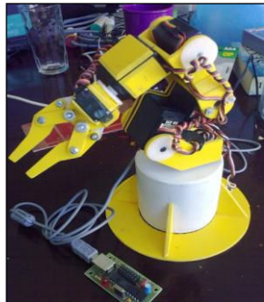
Fig. 4. Brazo robot con gripper utilizando servomotores Hitec HS-311
